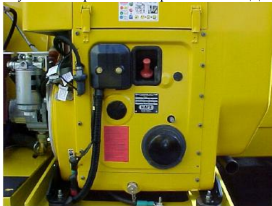
Рисунок 16. Уровень моторного масла в ДВС.
