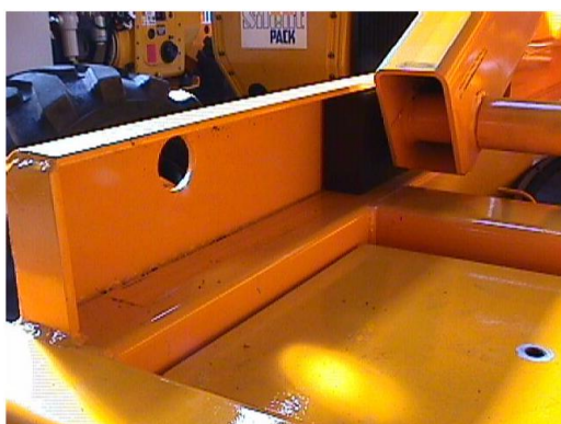
Рисунок 31. Направляющая скольжения пантографной стрелы
