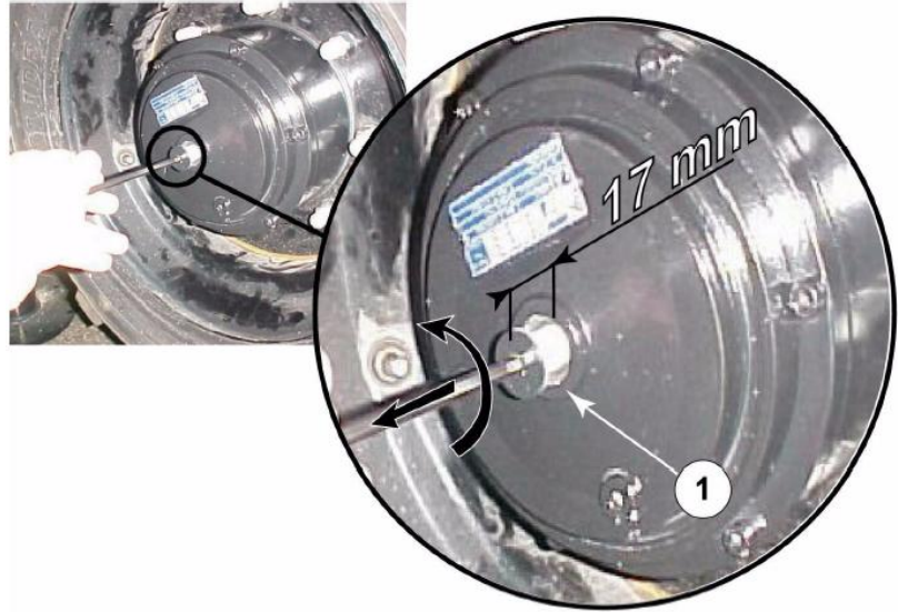
Рисунок 23. Отключение колес от колесных редукторов.
