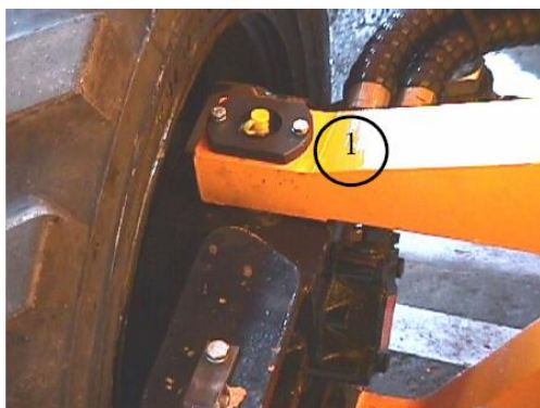
Рисунок 30. Шкворень поворотного колеса
