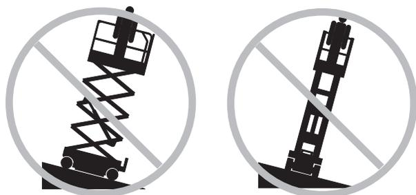
Не полагайтесь на звуковой сигнал наклона как на показатель выравнивания машины. Звуковой сигнал наклона включается на ходовой части только, если машина оказывается на крутом склоне.
