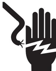
Подсоединяйте зарядное устройство аккумуляторов только к 3-проводной заземленной электрической розетке переменного тока.
