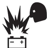
Аккумуляторы содержат электролит. При работе с аккумуляторами всегда носите защитную одежду и очки.
