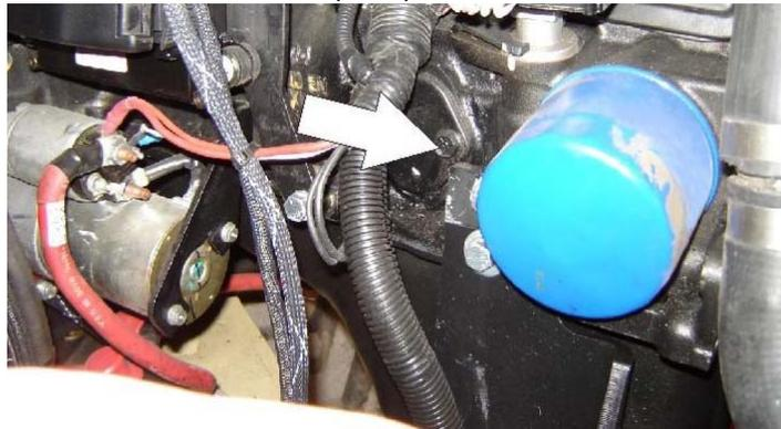
Точка (точки) смазки — заливная пробка/
