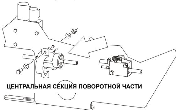
Точка (точки) смазки — заменяемый элемент
