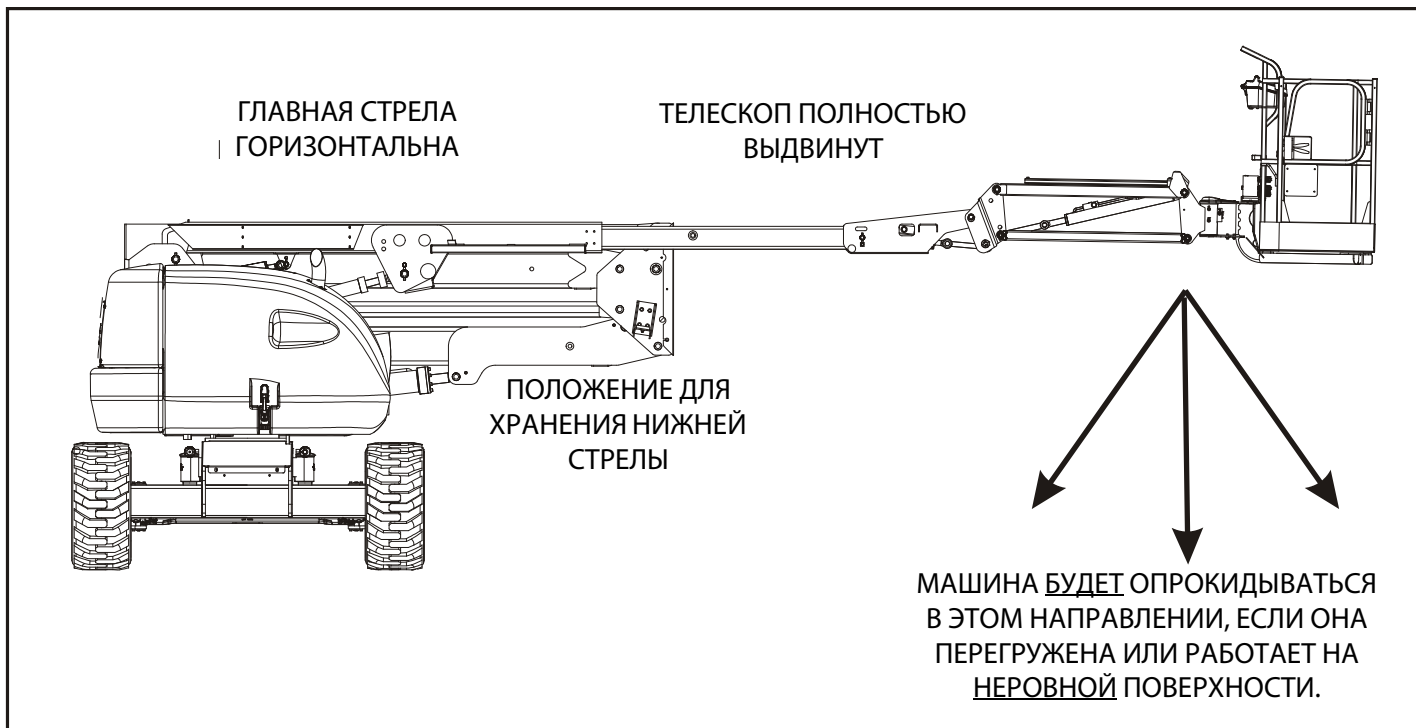
Рис. 4-1. Положение минимальной устойчивости против опрокидывания вперед
